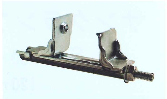
サンクランプM型は金属製型枠と木製型枠を連結させる時に使用する様開発されたものです。コンクリート釘やボルト・番線等で固定する必要がなく型枠にも損傷を与えず、らくに締めつけが出来、装脱が簡単で作業能率が倍増します。
